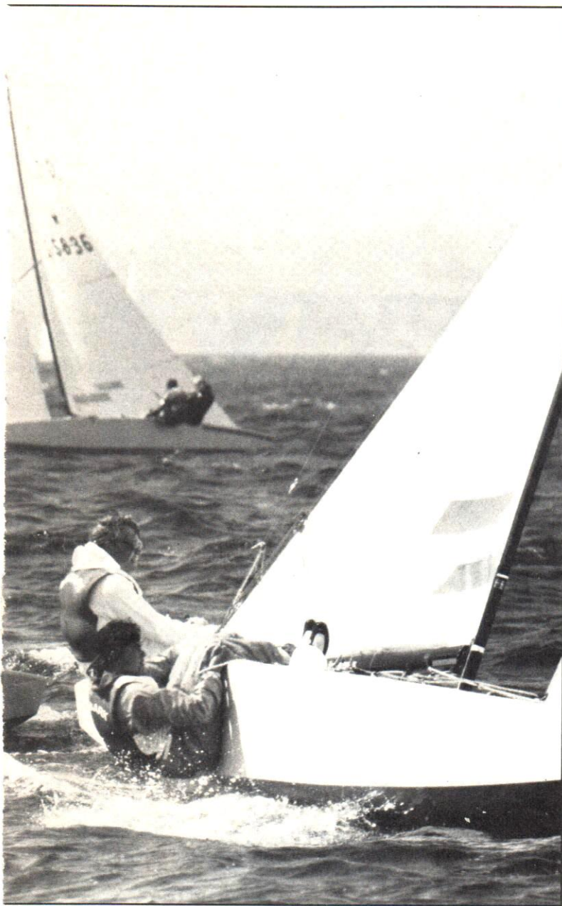
An der Kreuz. Optimalen Starboot-Trimmin erreicht man nur durch Gewichtsverlagerung weit nach außen. Zu erkennen die Backstagen für das sensible Rigg und die dünnen, flexiblen Mast-, „Peitschen“ der Olympiakklassen.
